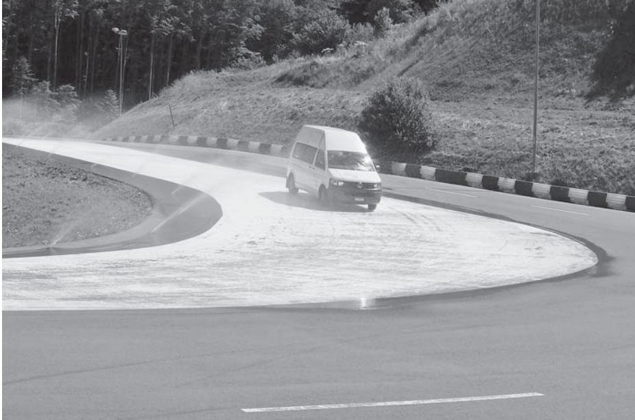
Mit 30-50 km/h auf dem speziellen Gleitbelag.
